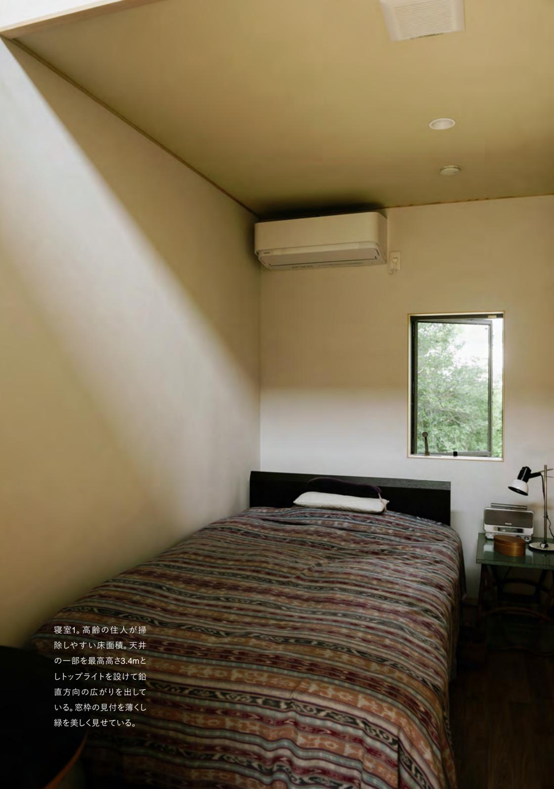
寝室1。高齢の住人が掃除しやすい床面積。天井の一部を最高高さ3.4mとしトップライトを設けて鉛直方向の広がりを出している。窓枠の見付を薄くし緑を美しく見せている。
